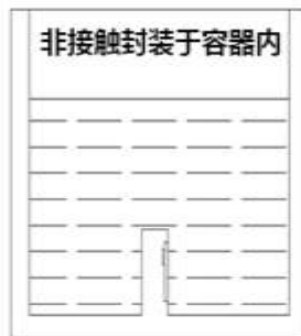
容器外壁非接触液位感应
