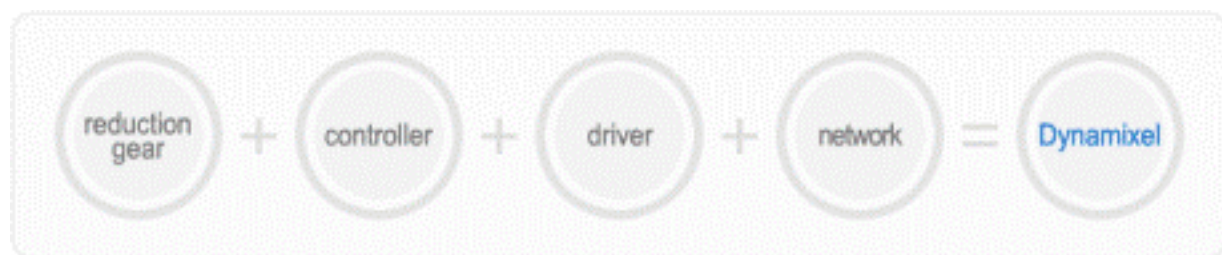
Figure 8 : Fonctionnement du servomoteur
