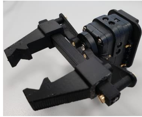
Figure 40 : Vue rapproché de la pince réalisée en fabrication par extrusion de fil chaud
