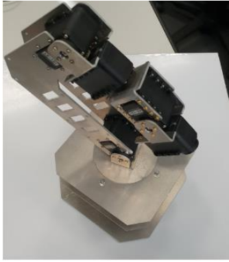
Figure 39 : Assemblage du bras robot en tôle d'aluminium
