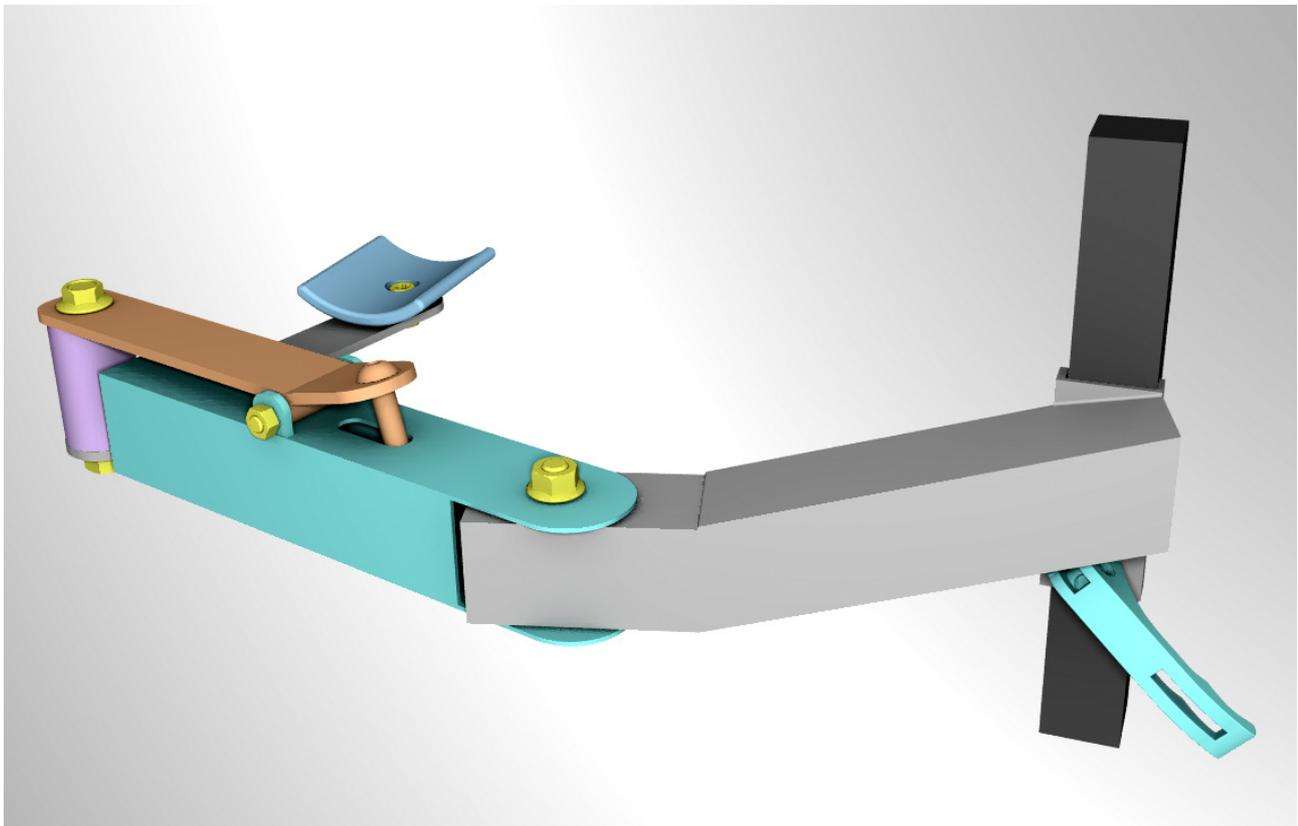
**Remarque :** Mettre des rondelles d'ajustage (très faible épaisseur) sur tous les axes de rotation pour en faciliter le fonctionnement.
