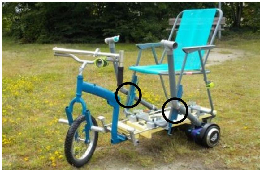
Vérifier l'angle maximum de l'**Hoverbike** en position arrière et en position avant. Cet angle doit être supérieur aux angles des routes à emprunter.
